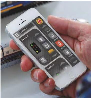
Eine besonders nützliche Funktion ist die Steuerung mittels des meist in solchen Geräten eingebauten Neigungssensors. Die Funktion kann per Knopfberührung (bei der Zugsteuerungsanzeige) aktiviert werden. Dann kann per Neigung des Tablets oder des Smartphones die Zuggeschwindigkeit gesteuert werden. In senkrechter Stellung ist die Geschwindigkeit dann Null, in waagrechter Stellung entspricht die Zuggeschwindigkeit der eingestellten Maximalgeschwindigkeit.
