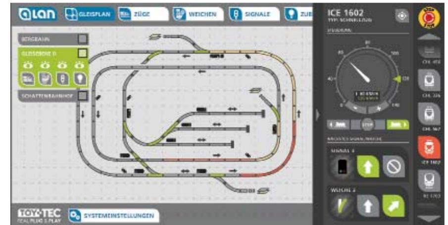
**Zentrales Steuerungselement:** Der interaktive und skalierbare Gleisplan zeigt neben der aktuellen Zug-Position den Standort der Weichen und Signale sowie des schaltbaren Zubehörs an.
