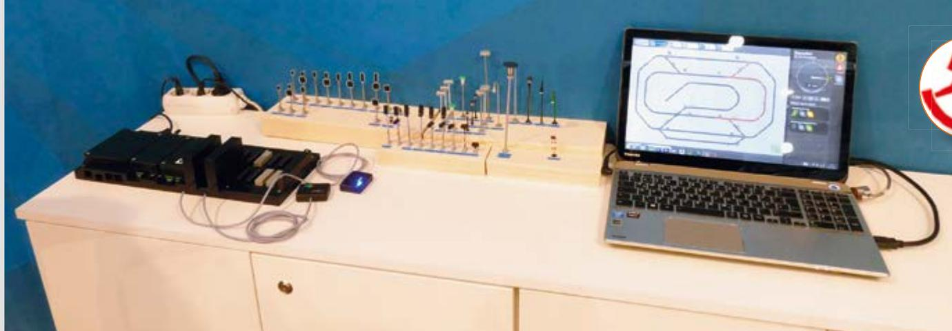
*En la izquierda de la imagen podemos ver la placa base y dos "ladrillos" conectados para hacer demostraciones sobre las señales luminosas (en el circuito estaban las mecánicas) y las farolas. A la derecha, un PC con el esquema del circuito, las señales, los desvíos y los cantones activados.*
