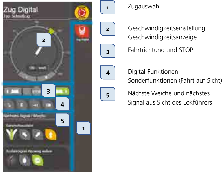
ABBILDUNG 37 ELEMENTE DES FAHRPULTS
