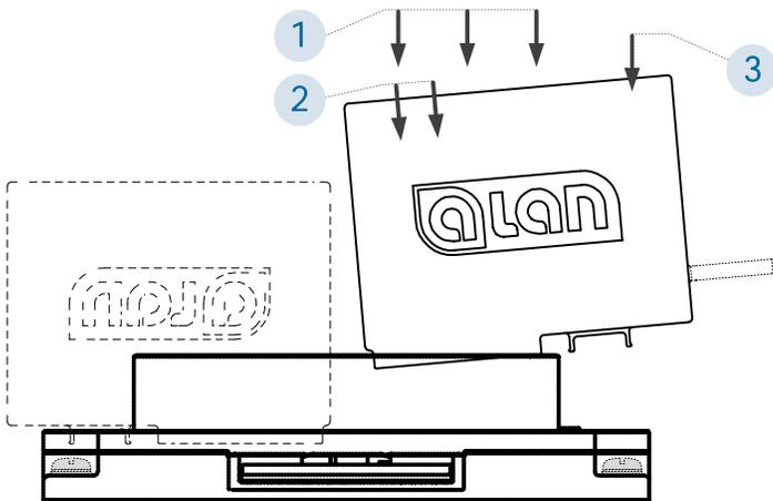
Die Bausteine können in jede BASE (Grundplatte) eingesteckt werden. Eine weitergehende Befestigung ist nicht nötig, auch dann nicht, wenn BASE unterhalb der Modellbahnplatte montiert ist. Die Einbaulage muss jedoch vertikal erfolgen, d.h., die Grundplatte (BASE) muss waagrecht auf oder unter einer stabilen Unterlage befestigt sein.
